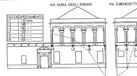
Fig. 14 Palazzo Doria. Estensimetri a filo per il controllo delle deformazioni dell'arco e catena livellometrica installata in corrispondenza del loggiato.
